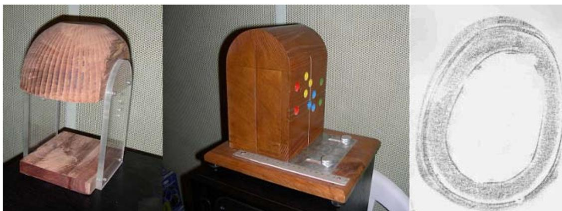
**Figura 8.** Elementos utilizados para obtener impresiones de la superficie de contacto: Dos dispositivos de montaje y plantilla de papel digitalizada de una impresión con tinta de almohadilla de PA tipo cobertor.
