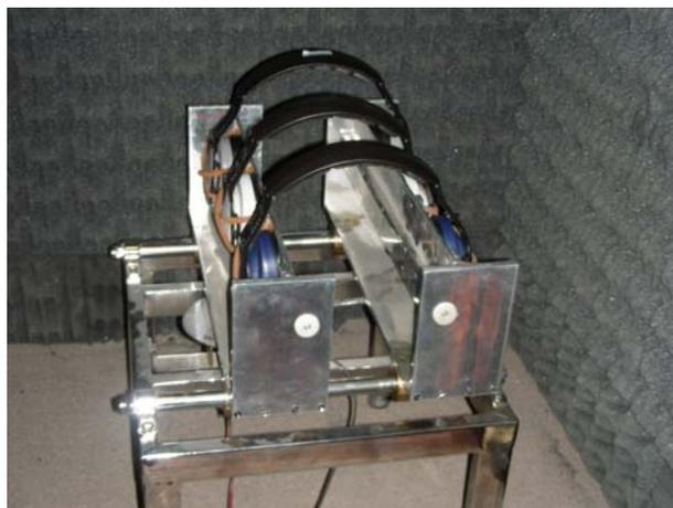
**Figura 7.** Dispositivo de ensayo de flexión de vincha (o brazos soporte, en el caso de cobertores acoplados a cascos).
