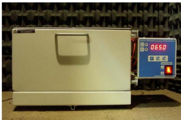
**Figura 9.** Dispositivo de ensayo de inflamabilidad – Mufla eléctrica.
