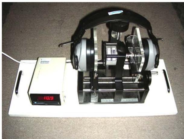
**Figura 6.** Dispositivo de montaje para la medición de fuerza de ajuste.
